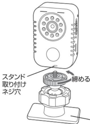
(2) ノブを右回りにゆるめ、ボールジョイントを軸にしてカメラの向き・角度を調整したら、ノブを左回りに締めて固定します。
