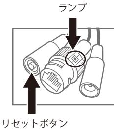
スピーカー非搭載機種は音声案内がありません。端子部の緑のランプが消えるまでリセットボタンを長押しします。リセットが完了しランプが点滅に変わりましたら、リセットボタンを2回連続で押します。
